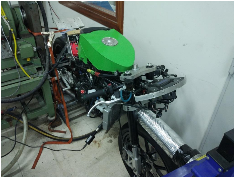
Ilustración 26. Moto sobre el banco de potencia lista para el mapeo.
