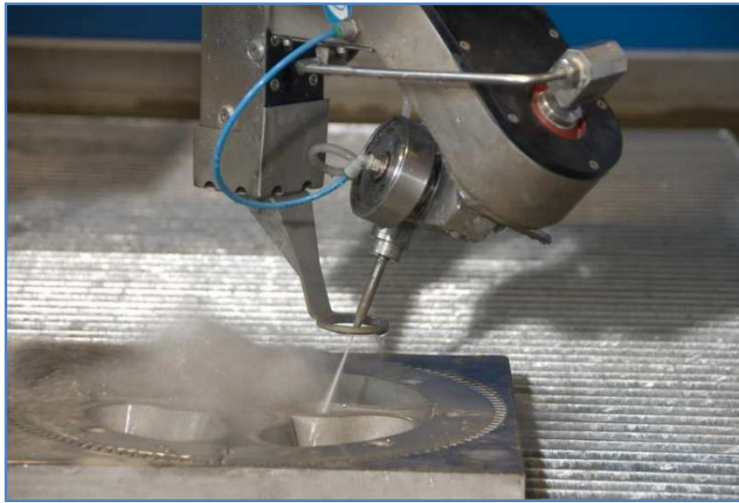
Ilustración 14. Corte por chorro de agua
