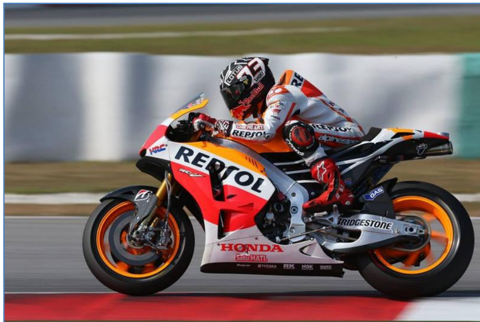
Ilustración 2. Moto Honda de Marc Márquez con su basculante de doble viga.
