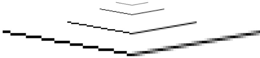
**Figura 7.6:** Líneas de la izquierda obtenidas con el algoritmo de Bresenham, líneas de la derecha obtenidas con el algoritmo de Xiaolin Wu.
