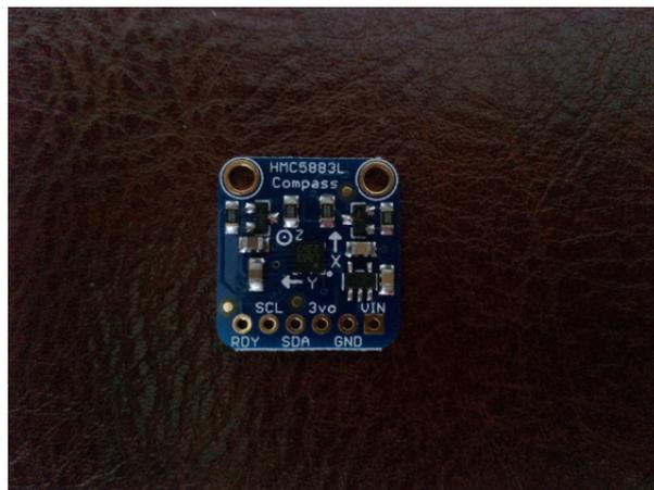
**Figura 3.6:** Magnetómetro HMC5883L
