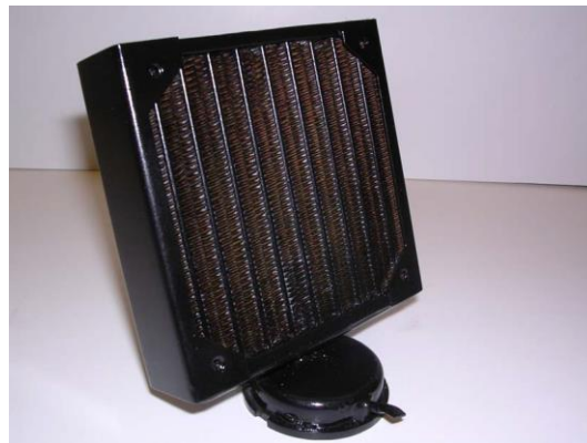
Figura 1.21. Termosifón y tubos de calor para la refrigeración de un microprocesador.
