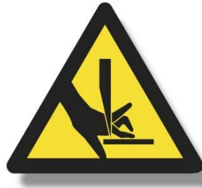
Imagen 7.3: riesgo por corte o cizallamiento
