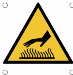
Imagen 7.4: riesgo por quemadura
