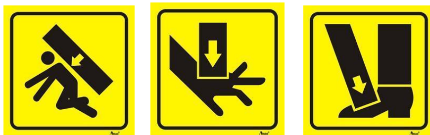
Imagen 7.2: riesgo por aplastamiento
