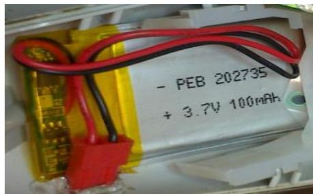
*Figura 28. Batería LiPo 3.7V.*
