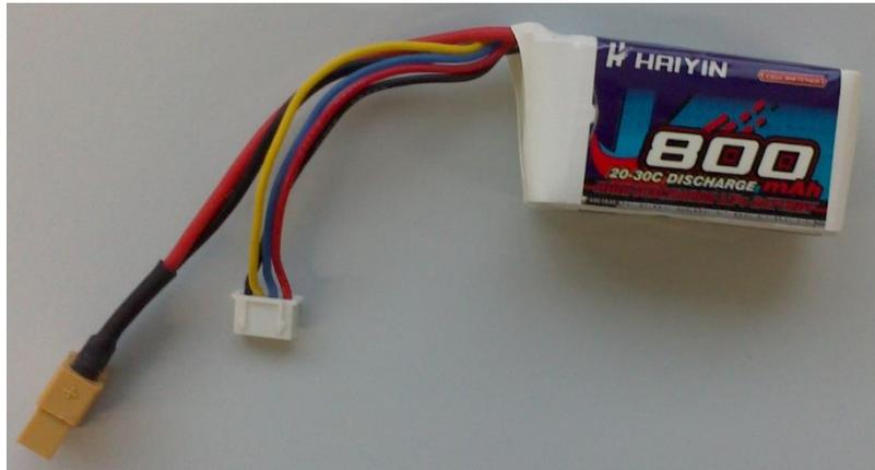
*Figura 24. Batería LiPo 11.1V.*
