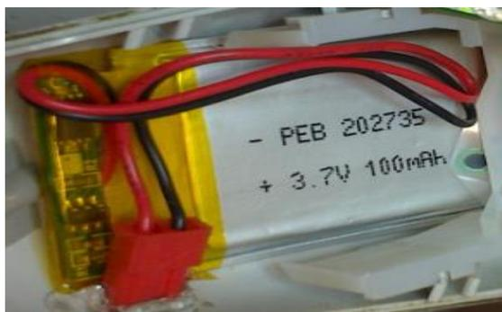
*Figura 16. Batería LiPo 3.7V.*
