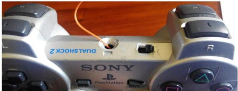
Figura 23. Interruptor y conexión carga batería.
