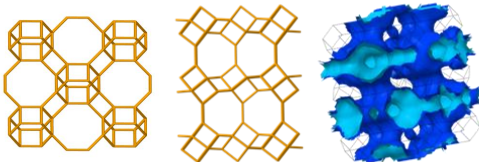
Figura 2.8. Estructura y canales del SAPO-18.
