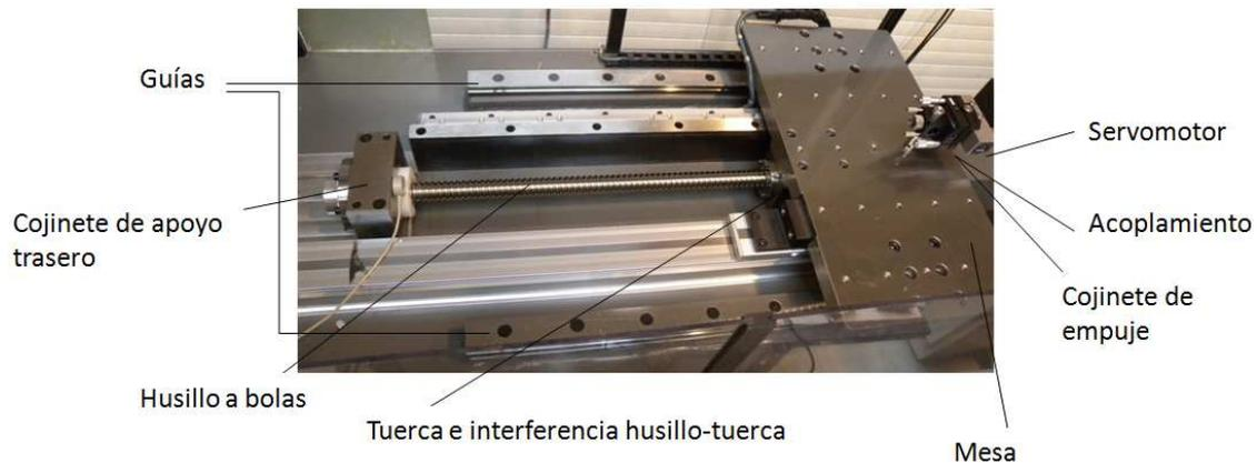
Figura 3. 8. Banco de ensayos del accionamiento husillo a bolas.
