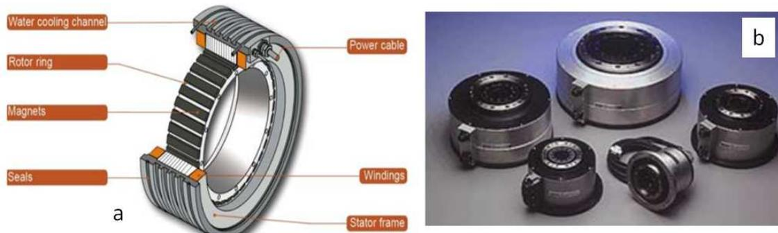
Figura 2. 21. Motor de par. a) Construcción, b) Distintas gamas.
