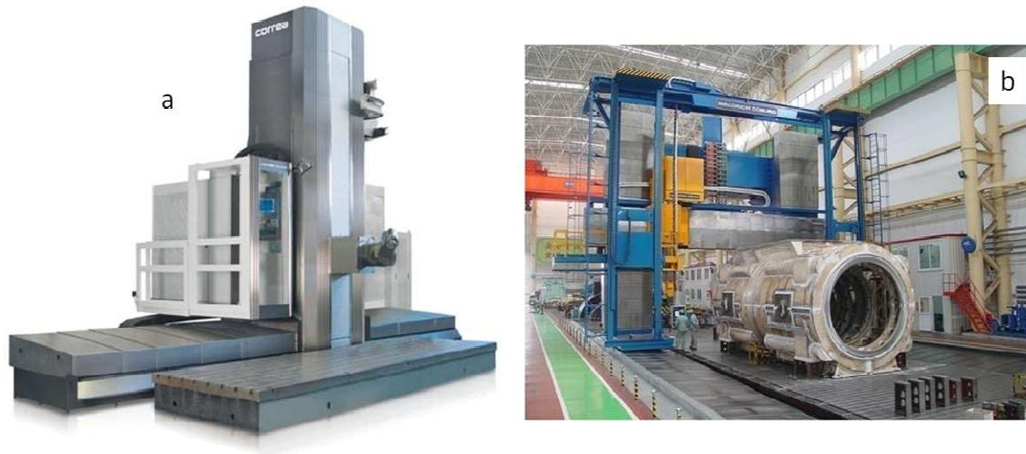
Figura 2. 10. Fresadoras de grandes dimensiones. a) Columna móvil, modelo Magna de Nicolás Correa, b) Máquina Waldrich- Coburg con accionamiento piñón-cremallera.
