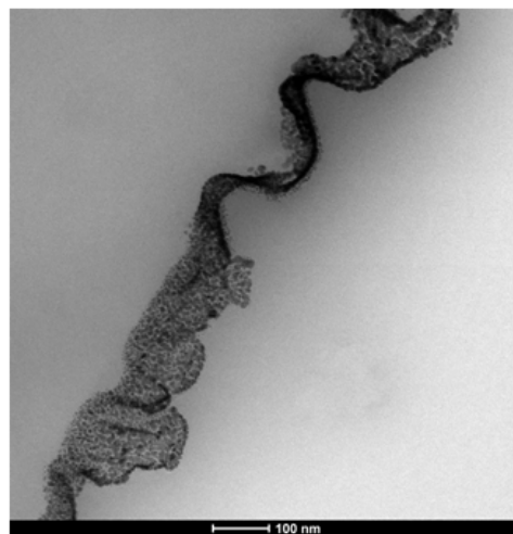
Figura 6. Imagen de TEM correspondiente a un filme de PCL modificado superficialmente con el péptido antifouling
