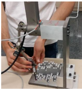
Figura 7. Medida de los puntos con dispositivo de tracking.
