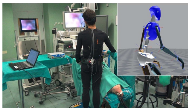
Figura 2. Registro de la postura del cirujano mediante el sistema de sensores inerciales Xsens® durante el transcurso del procedimiento quirúrgico.
