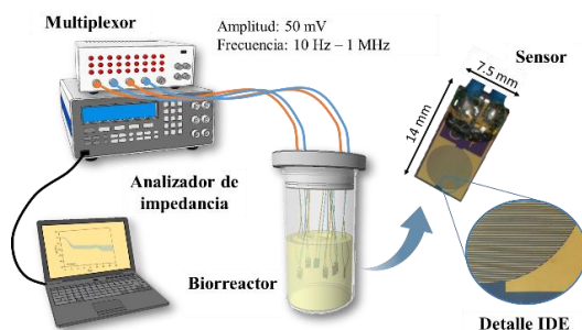
Figura 1. Setup y biosensor empleados durante los ensayos.
