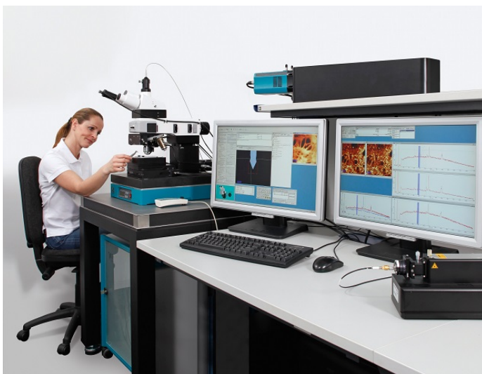
Figura 2.6. Equipo de Espectroscopía de Raman Confocal unido a Microscopío de Fuerza atómica.
