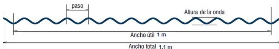
Figura 33. Esquema de chapa acanalada.
