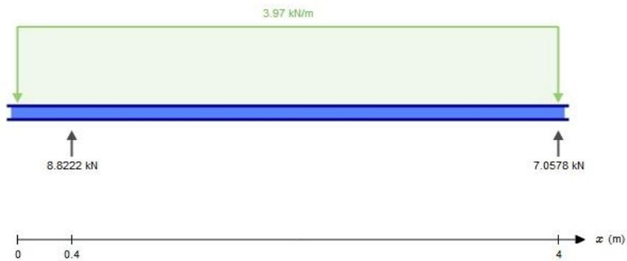
Figura 41. Esquema de la viga hip 1
