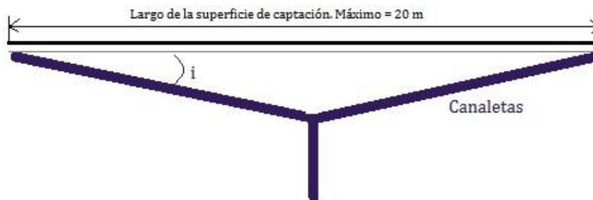
Figura 34. Croquis de la disposición de las canaletas
