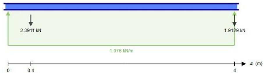
Figura 44. Esquema de la viga hip 2
