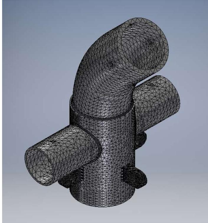
*Ilustración 1.25. Modelo mallado para el análisis tensional de la unión*
