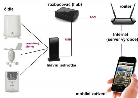
Figura 10: Esquema de conexiones de Oregon Scientific LW301
