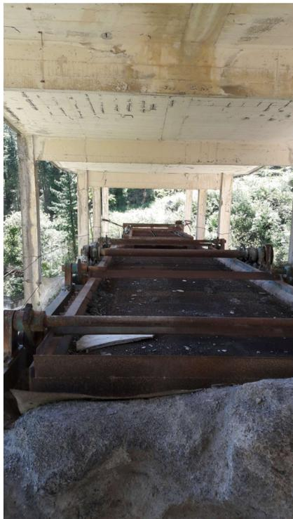
Figura 17. Cinta transportadora de material no machacado.
