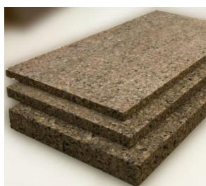
4.36. Irudia: Kortxo panela eta kortxo aleak. (BCK)
