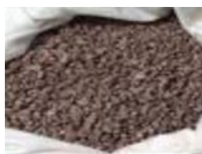
4.36. Irudia: Kortxo panela eta kortxo aleak. (BCK)
