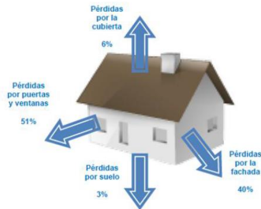
Figura 2. 5: Esquema de pérdidas térmicas a través de la envolvente. (EVE)
