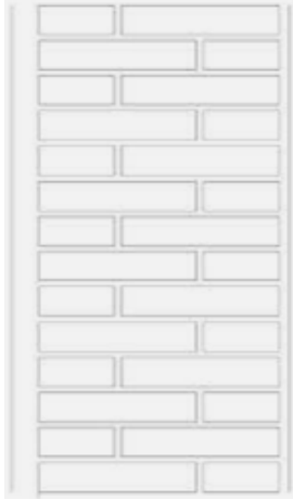
3.5. Irudia: Bi aldeetan estaldutako orri bakarreko fatxadaren eraikuntza-sekzioa (1,5 oindun adreilu zulatua). Eusko Jaurlaritzako birgaitze energetikoko katalogoa
