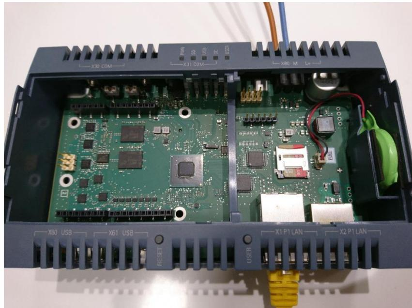
Figura 8. Interior del SIMATIC IOT2040
