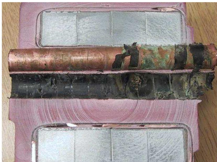
*Imagen 1. Transformador de corriente seccionado para mostrar los daños de una descarga interna*
