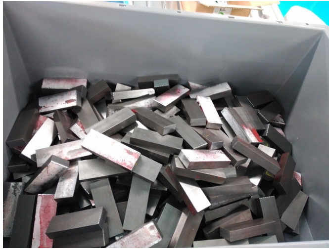
Figura 6: Piezas a identificar y extraer del contenedor por el robot
