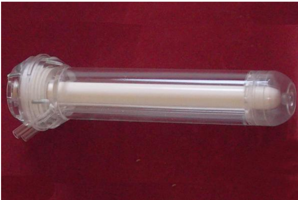
Figura 1. Suplemento del Kappabridge para medir variaciones de alta temperatura de susceptibilidad magnética (Tomado de AGICO, 2017).
