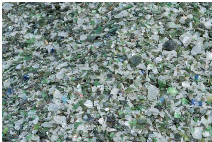
Figura 9. Calcín en planta de tratamiento
