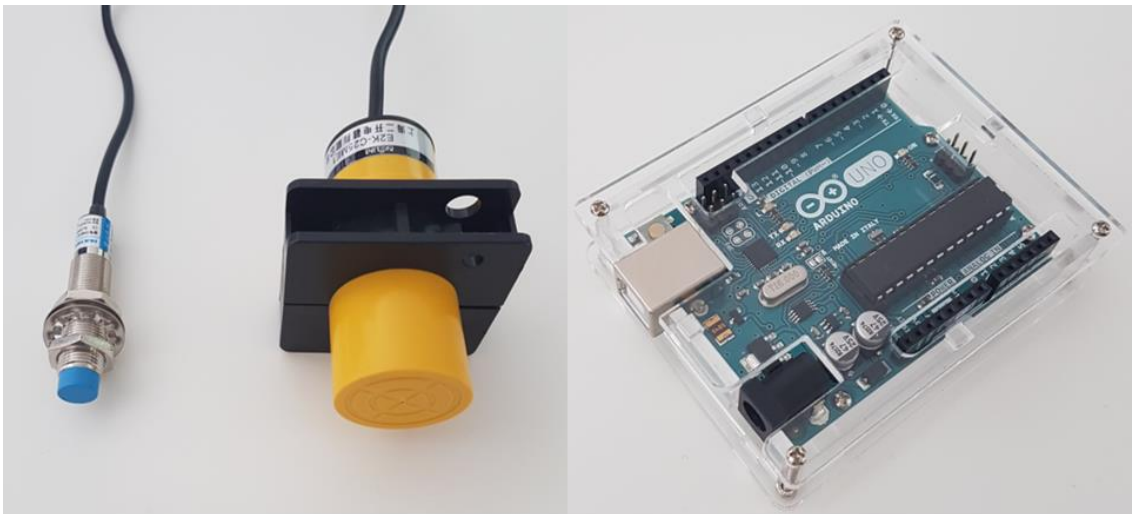
Figura 1. Sensores inductivo, capacitivo y Arduino
