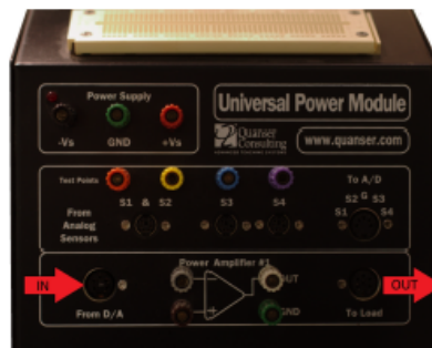
Figura 2.4: Panel de conexiones frontal del UPM2405.
