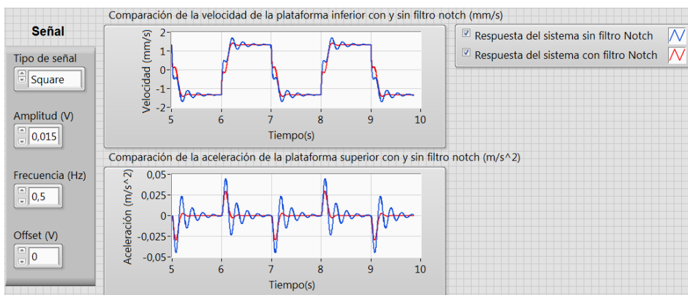
Figura 5.4: Comparación entre la dinámica simulada de la plataforma con y sin el filtro notch aplicado.
