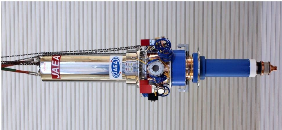
*Figura 1.23. Imagen de un girotrón en desarrollo para su funcionamiento en ITER [27].*
