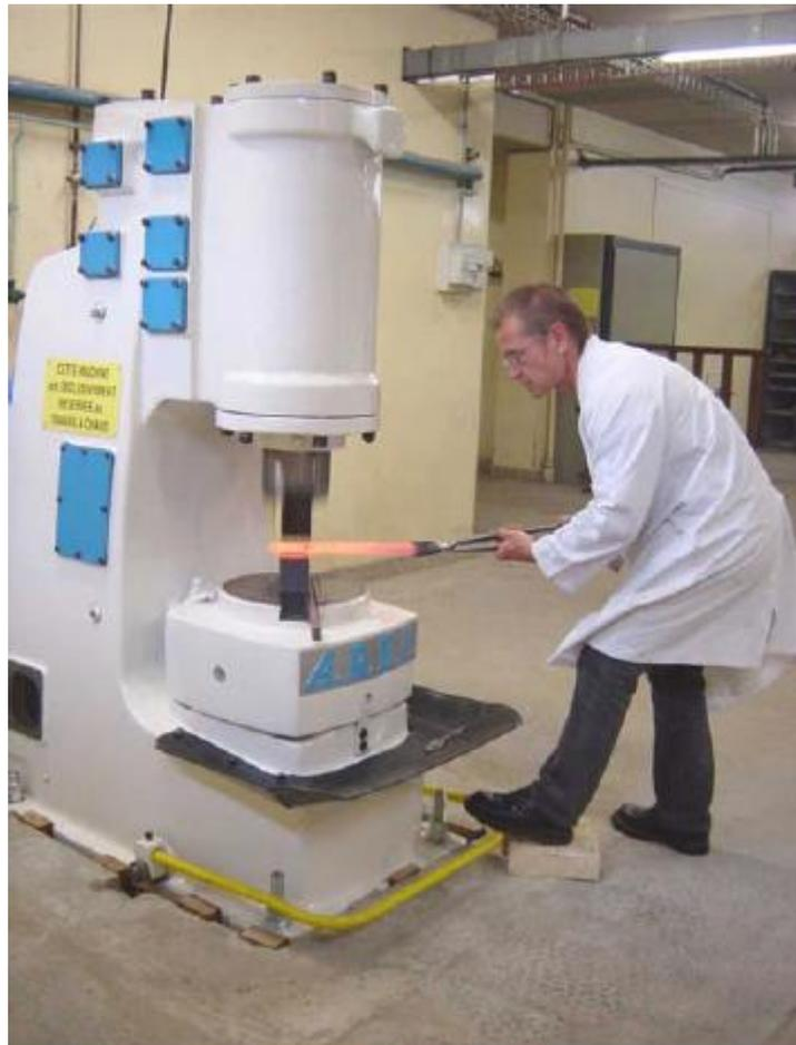
*Figura 2.2. Forjado de una barra de hierro [39].*
