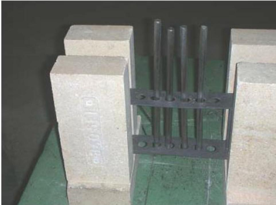
*Figura 2.13. Dispositivo de enfriamiento vertical [39].*
