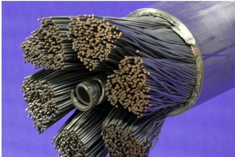
*Figura 1.12. Hilos superconductores y no superconductores rodean al canal central dispuesto para el helio [27].*
