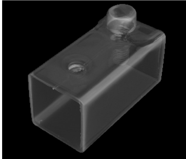
Fig. III.40. Resultado de la inspección 3D digital RX. La hoja de aluminio no se muestra debido a su diferente penetración de la radiación RX.
