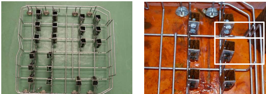
Fig. III.27. Componentes en el soporte al inicio y tras 48 h de exposición a nieblas salinas.
