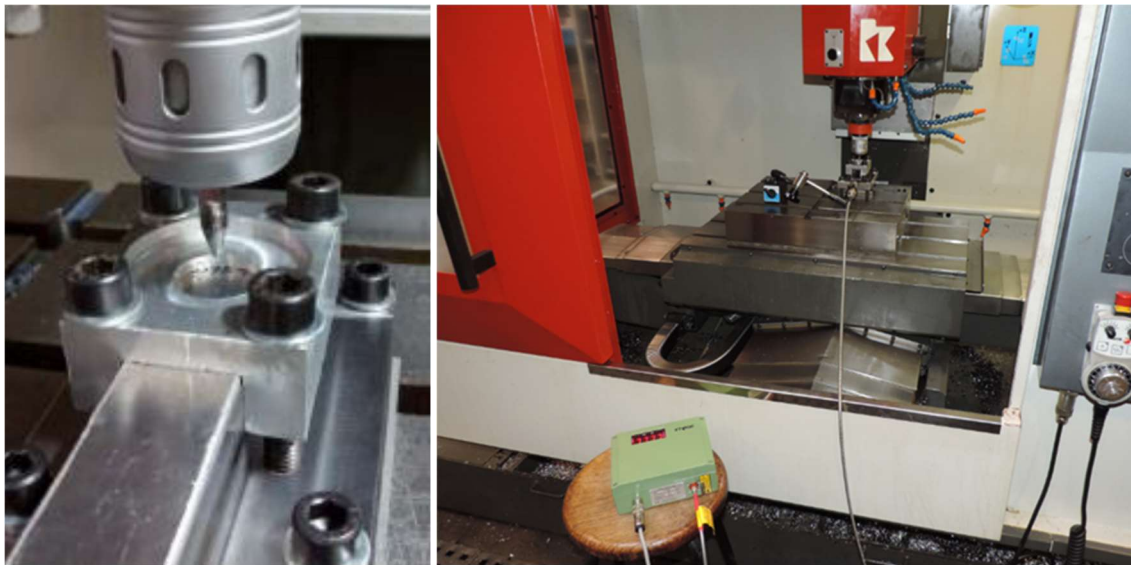
Fig. III.4. Utillaje empleado en los ensayos sistemáticos y detalle de la medición de temperaturas.
