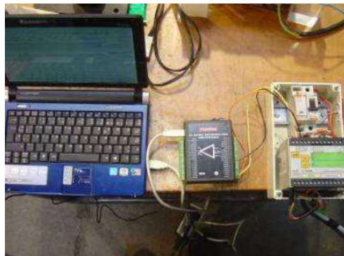
Fig. III.5. Sistema de medida DDU Artis para la medición del par y la fuerza.
