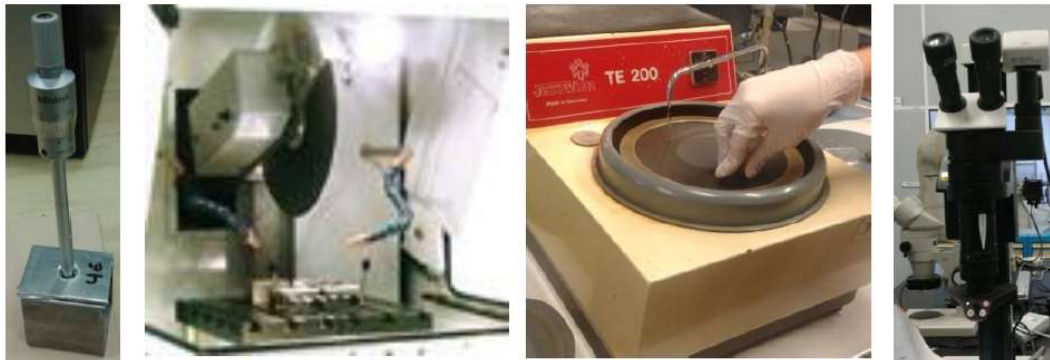
Fig. III.14. Proceso para la medición de las características geométricas de los agujeros.
