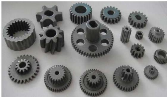
Figura II.4 Conjunto de engranajes obtenidos mediante sinterizado
