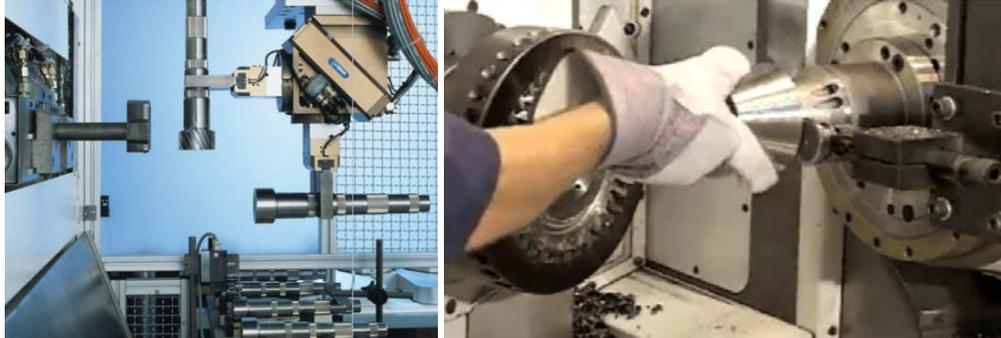
Figura I.24 Inserción del “blank” en máquinas específicas de tallado
