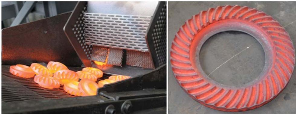
Figura II.8 Engranajes conformados mediante forjado
