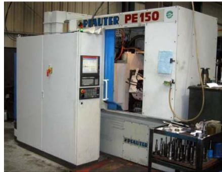
Figura I.22 Fresadora CNC para la fabricación de engranes con fresa madre
