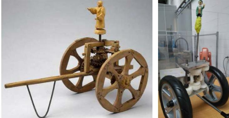
Figura I.4 Carro que apunta hacia el sur (150-250 d.C.) y el realizado en la UPV en 2016
