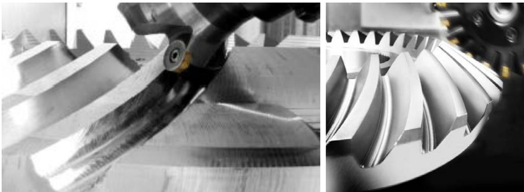
**Figura II.76** Desbaste y acabado realizado mediante *uP-Gear Technology*
