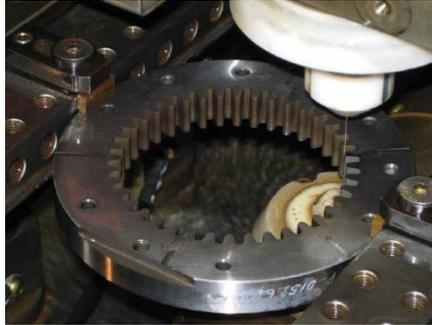
Figura II.29 Generación engranaje mediante electroerosión [Ellis, 2014]
