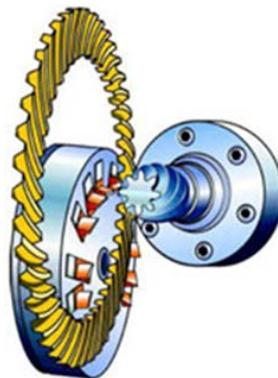
Figura II.49 Movimiento relativo de epicicloide extendida
