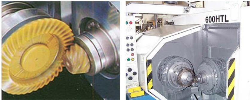
Figura II.35 Lapeado de engranajes espirocónicos. Gleason Phoenix – Turbo Lapper 600HTL
