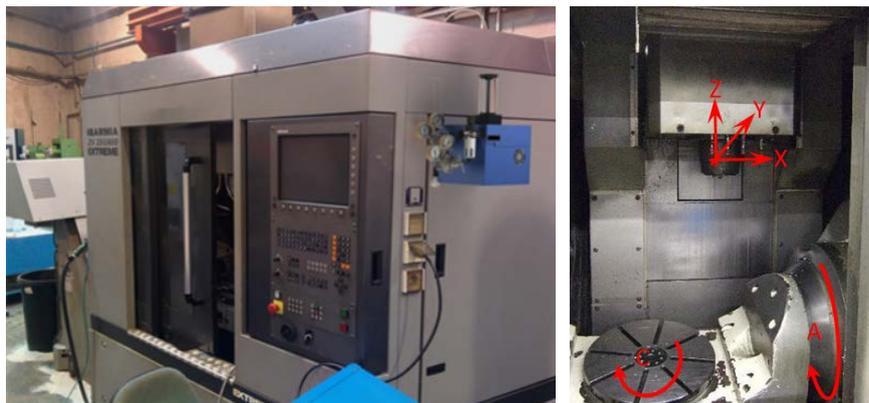
Figura III.31 *Ibarmia ZV25/U600* situada en el taller de ingeniería mecánica de la ETSI de Bilbao
