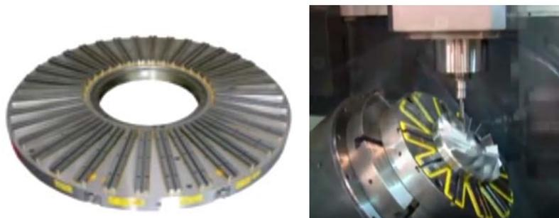
Figura I.32 Sujeción de pieza en utillaje magnético
