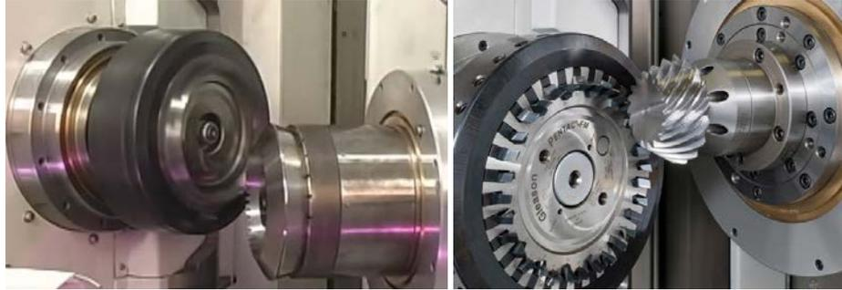
Figura II.47 Dentado Gleason de altura variable
