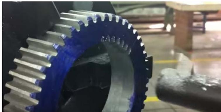
Figura II.12 Tallado de un engranaje interior por cepillado
