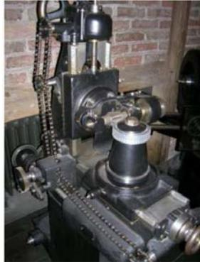
**Figura I.15** Máq. desarrollada por H. Pfauter para la fabricación de engranes mediante fresa madre (1897)
