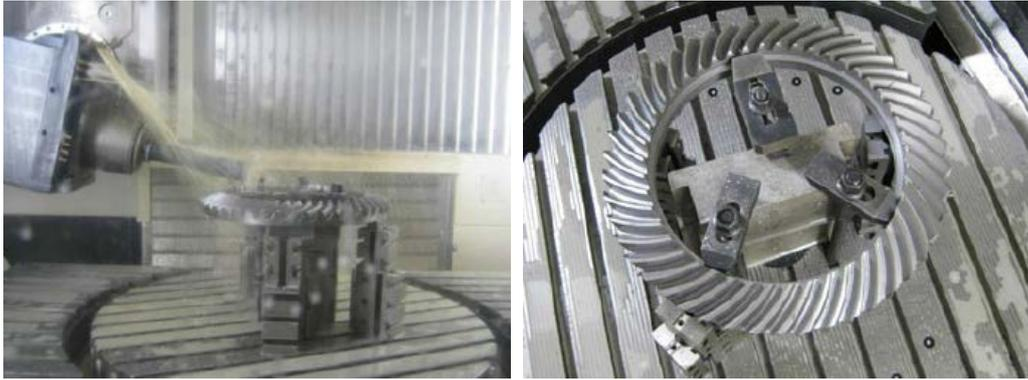
Figura II.58 Mecanizado con herramienta de disco con extremo cóncavo
