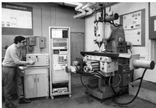
Figura I.21 Primera fresadora CNC utilizando para su control una computadora HP-2100 (McMaster Uni, 1973)
