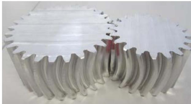
Figura II.67 Par de engranajes de geometría compleja
