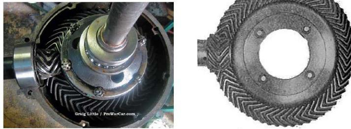
Figura I.17 Mecanismo piñón-corona con engranes *chevron* o helicoidales dobles
