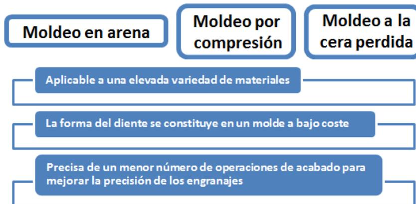
Figura II.2 Clasificación y ventajas de los procedimientos de conformado por fundición
