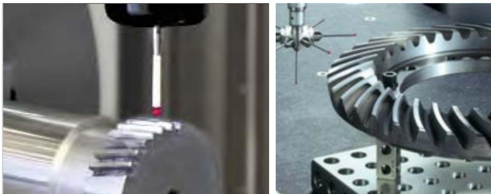
Figura II.68 Medición en la propia máquina de mecanizado
