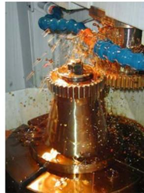
Figura II.21 Proceso de tallado y mecanizado en máquina
