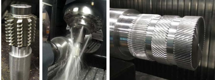
Figura II.16 Hobbing en máquina Ibarria en instalaciones de Azkoitia en 2017
