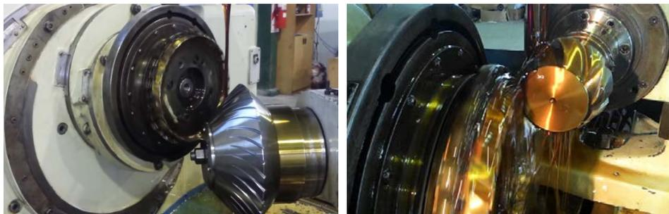
Figura II.51 Fabricación de engranajes mediante el sistema Oerlikon
