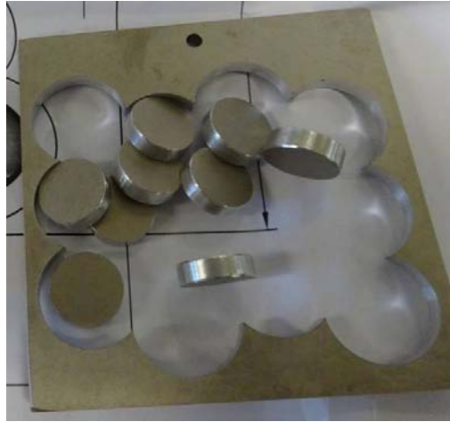
Figura 5.3. Corte de las muestras de PBs en forma de discos de \varnothing 11 \times 4 mm.
