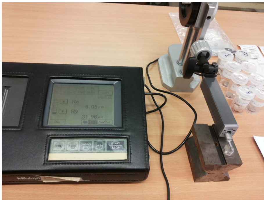
Figura 5.19. Rugosímetro Mitutoyo SurfTest SJ-301. Medida de rugosidad de una muestra de Al recubierta de Ni-P.
