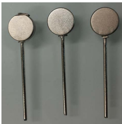
Figura 5.4. Discos de Al con vástago incorporado tras ser procesados industrialmente.
