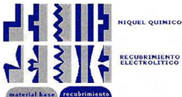
Figura 5.5. Recubrimiento níquel químico por electroless con excelente uniformidad [53].
