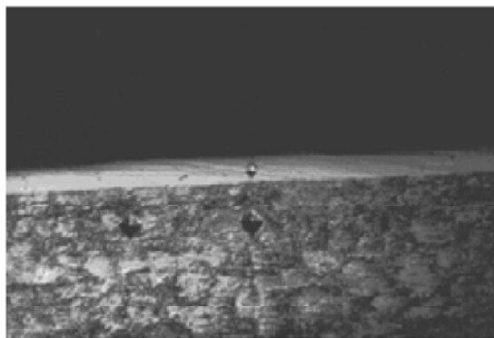
Figura 5.6. Estructura amorfa de una capa de níquel químico (10÷12%P) [53].
