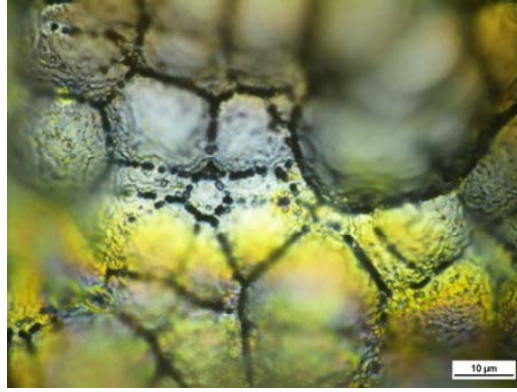
Figura 5.31. Superficie de la muestra Ni-P 30 (x100) tras pasar un ensayo de polarización potencioestática de 5h.
