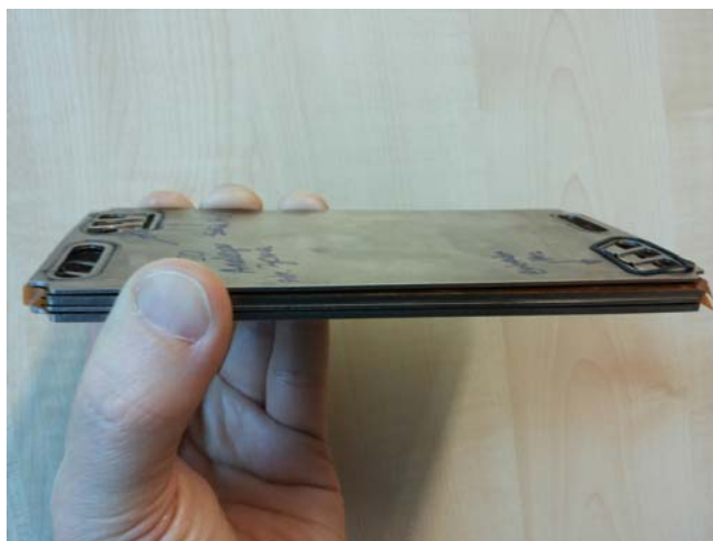
Figura 5.42. Vista del montaje de las placas con recubrimientos de Ni-P 40 y HT-MEA del stack.
