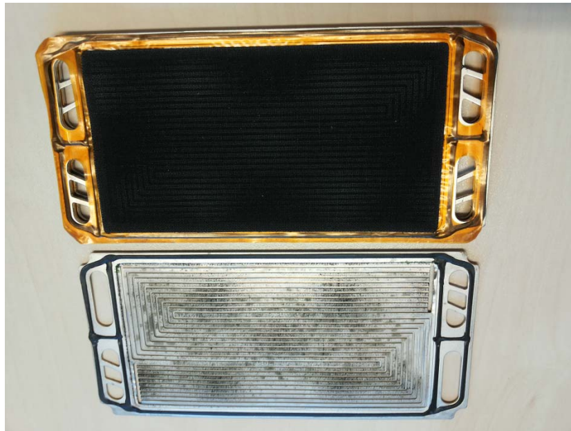
Figura 5.43. Vista de los canales de tipo serpentin, junta de sellado y HT-MEA de una de las monoceldas del stack después del ensayo.
