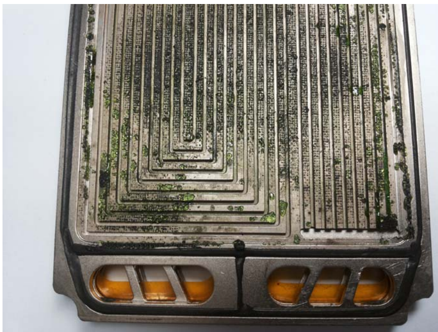
Figura 5.46. Estado superficial de las placas de Al recubiertas de Ni-P 40, después del test de funcionamiento. Se observaron depósitos tanto en el interior como fuera de los canales de flujo.
