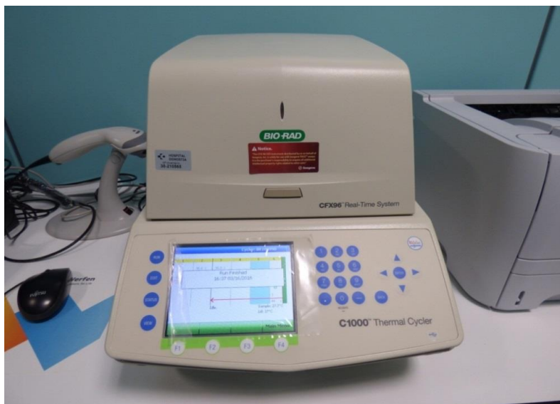
Figura 8.- Termociclador CFX96 (BioRad) empleado en pruebas de PCR en tiempo real multiplex.
