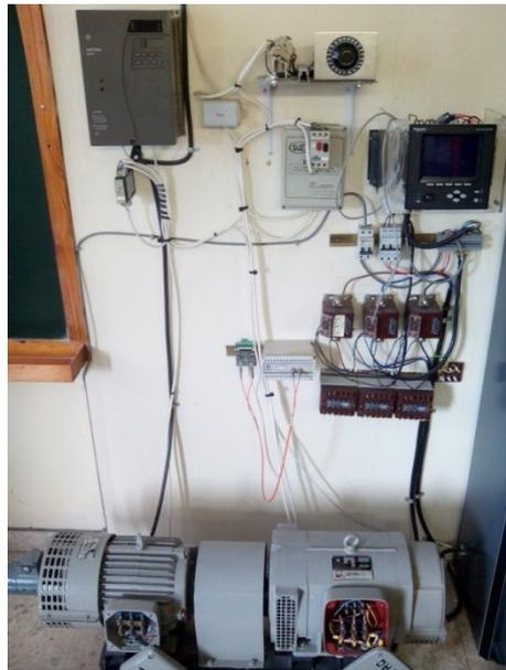
*Figura 7.2.1. - Grupo Motor-Alternador con elementos de control*
