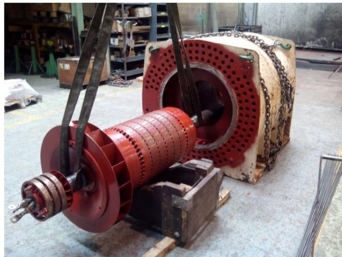
*Figura 6.5.3. – Colocación del rotor en el estator de un motor de inducción.*
