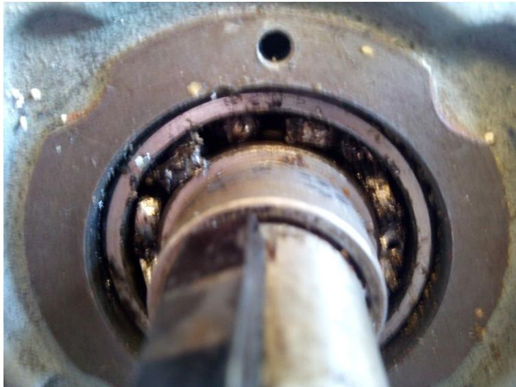
*Figura 9.1.26. - Rodamiento con arena y jaula abierta*
