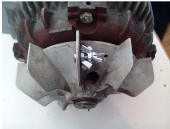
*Figura 9.1.20.- Masa añadida en el ventilador*
