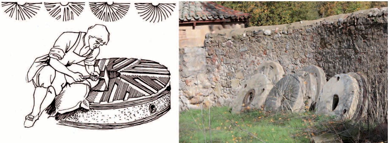
Figura 3. Muelas procedentes de la aceña del Arrabal (fotografía de C. Hernando) y esquema de los tipos de picadura (a partir de SÁENZ DE SANTAMARÍA, 1985: 71, fig. 8).
