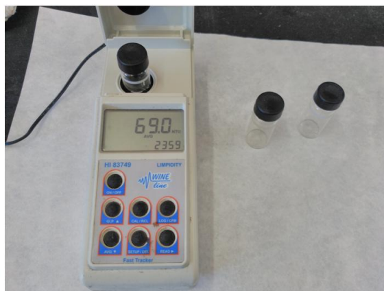
2.6 Irudia. Uhertasuna neurtzeko turbidimetroa eta honen bialak.
