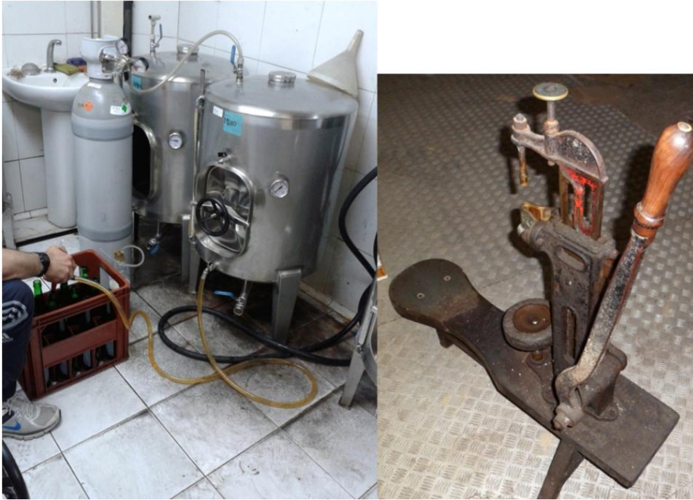
3.13 Irudia. Sagardo botilak betetzeko sistema eta kortxoa ipintzeko makina.
