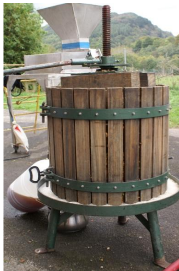
3.18 Irudia. Narbarte Gorria sagar motarekin erabilitako prentsa bertikala.
