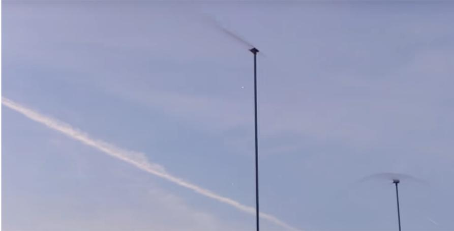
**Figura 1.1:** Aspersores situados en una zona alta para simular la lluvia.
