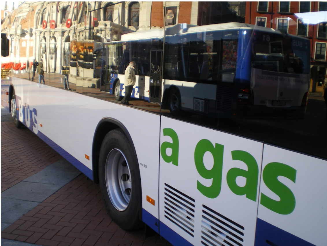
Ilustración 7. Autobús propulsado por GLP en Valladolid.
