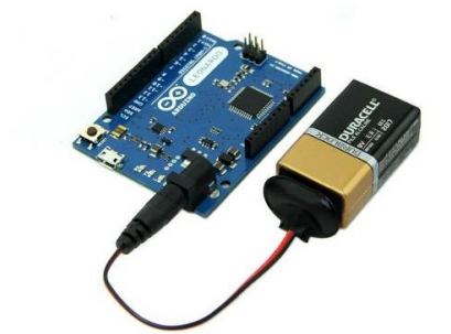
Figura 3.2. Alimentación vía Coaxial 2,1mm
