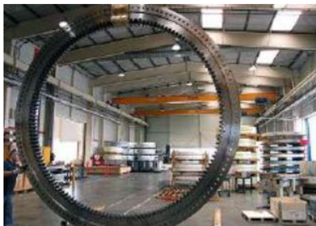
32. irudia. Barne horzdun dimentsio handiko errodamendua.
