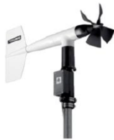
12. irudia. Helize motako anemometroa.
