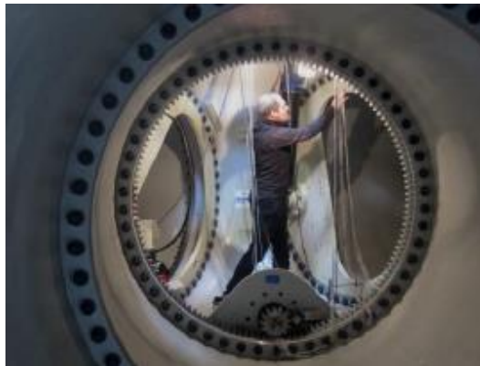
44. irudia. Palen barne hortzdun errodamendua.
