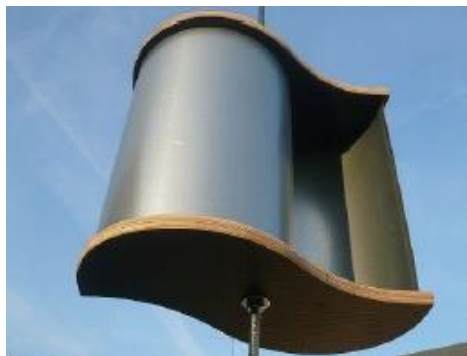
17. irudia. Savonius motako aerosorgailua.
