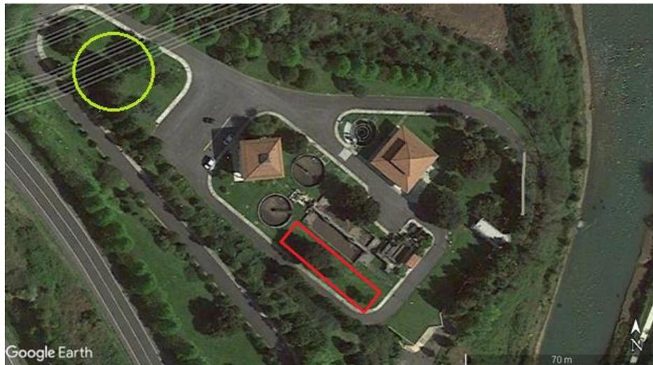
Figura 31: Croquis del emplazamiento para el proceso de membrana (rojo) y el tanque de almacenamiento (verde). [57]
