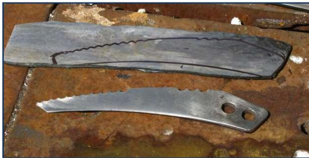
**Figura 18:** Hoja de piolet recortada de chapa de acero al carbono 15N20 [20]
