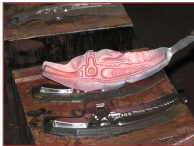
**Figura 17:** Cabeza forjada en una sola pieza de Grivel [19]
