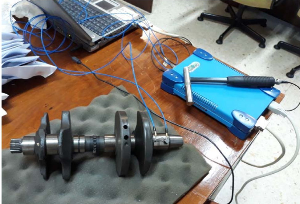
Figura 6. Montaje para el análisis modal sobre una espuma elástica.
