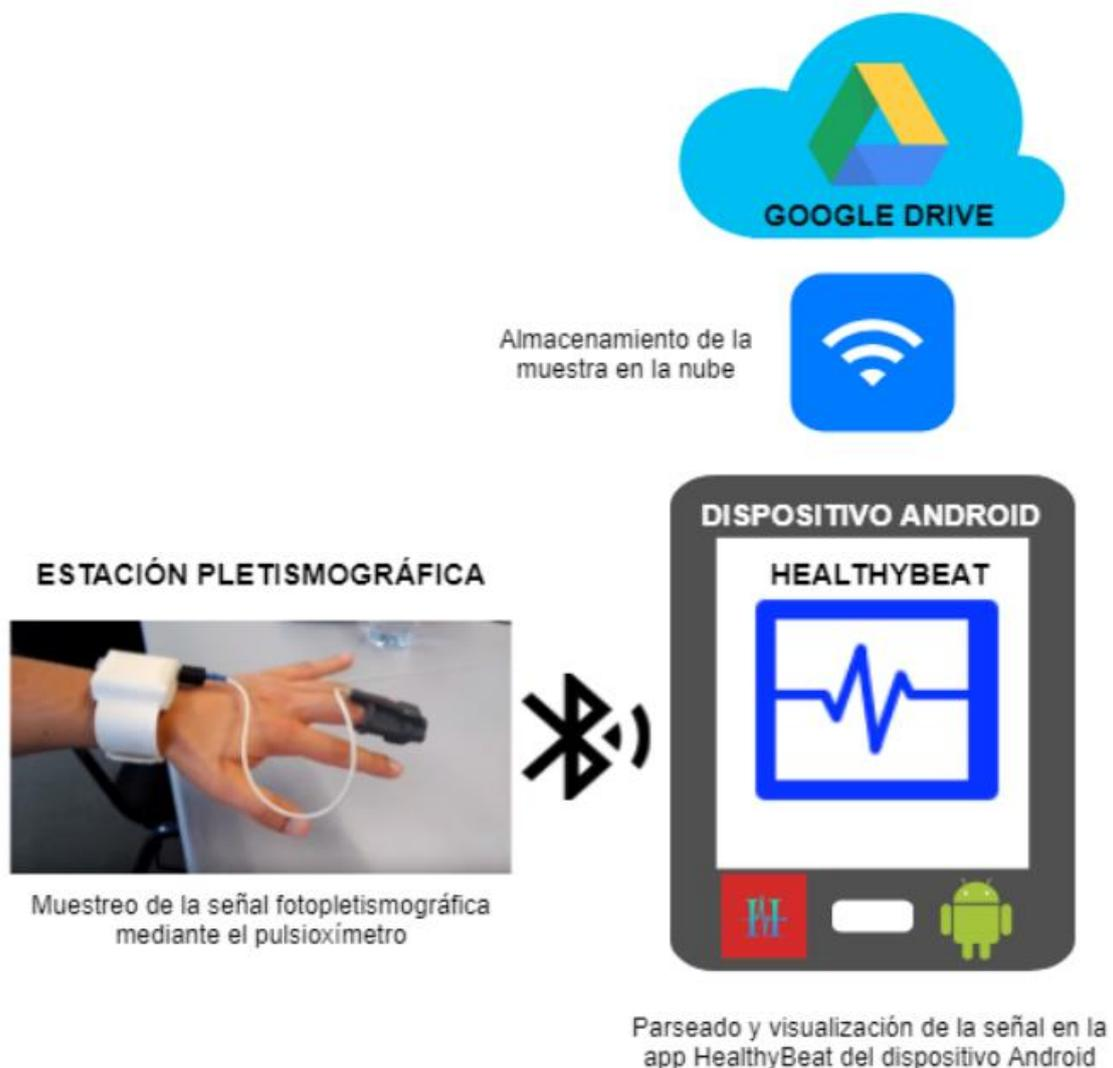
Ilustración 22: Diagrama de bloques con pulsera (1º versión)
