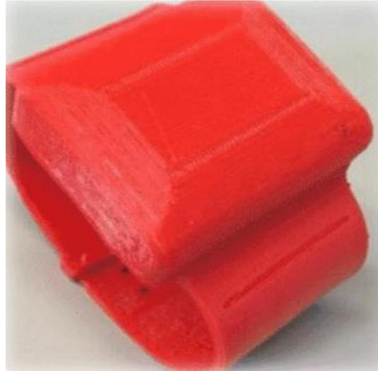
Ilustración 7: Pulsera con estación pletismográfica integrada
