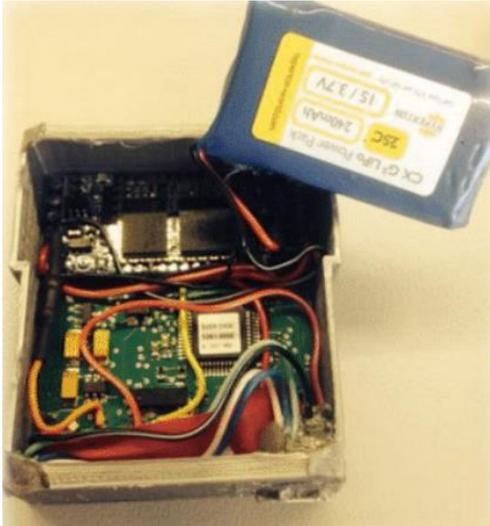
Ilustración 6: Carcasa con los componentes de la estación pletismográfica
