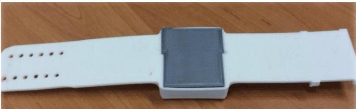
Ilustración 5: Pulsera para la estación pletismográfica construida mediante una impresora 3D
