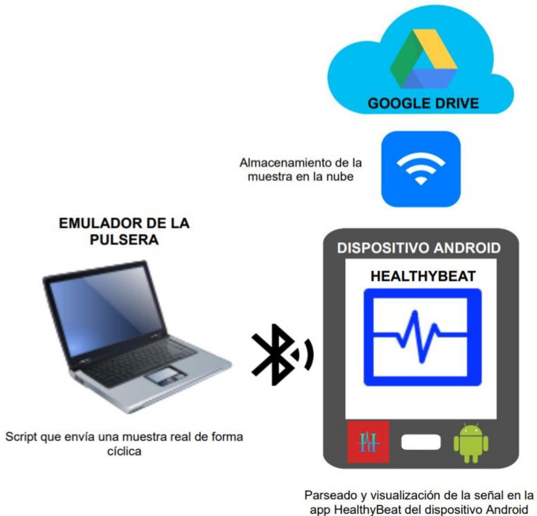
*Ilustración 23: Diagrama de bloques con emulador de pulsera (2º versión)*
