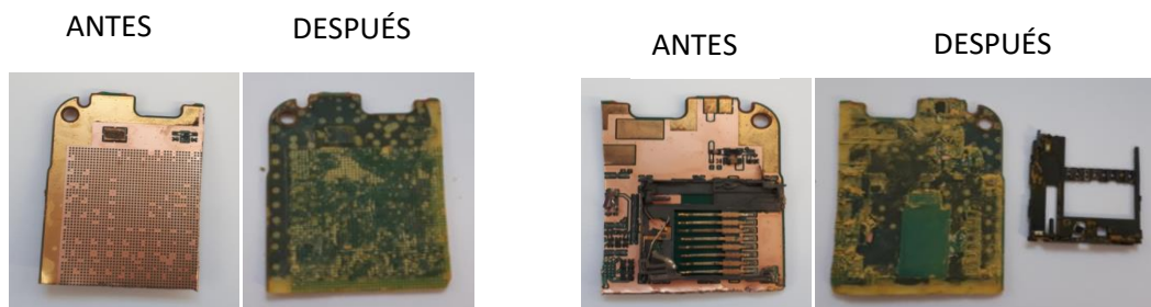
Figura 21. Placa de un PCB antes y después del ensayo biótico.
