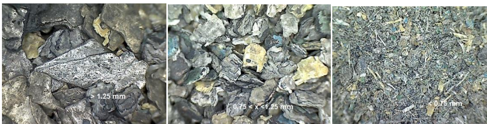
Figura 9. Muestra triturada con un tamaño > 1.25 mm (izda), entre 1.25 y 0.75 mm (centro) y > 0.75 mm (dcha).
