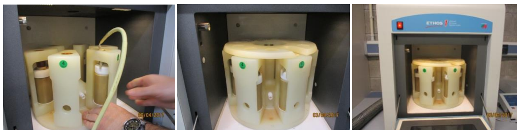
Figura 12. Detalle de la colocación de los recipientes de teflón en el carrusel del digestor.
