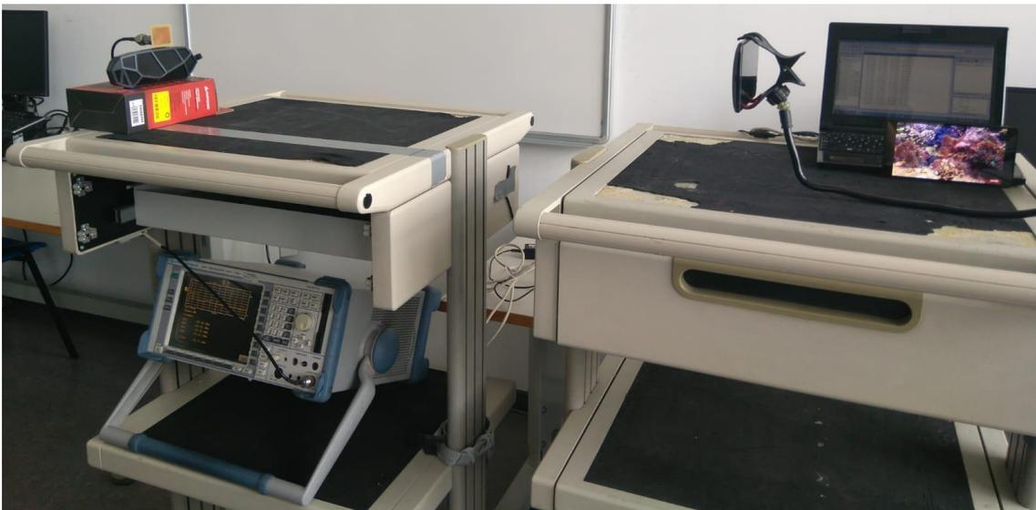
Figura 17. Montaje para medidas de caracterización en funcionamiento en situación real
