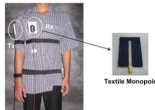
Figura 9. Localización de antenas Tx y Rx
