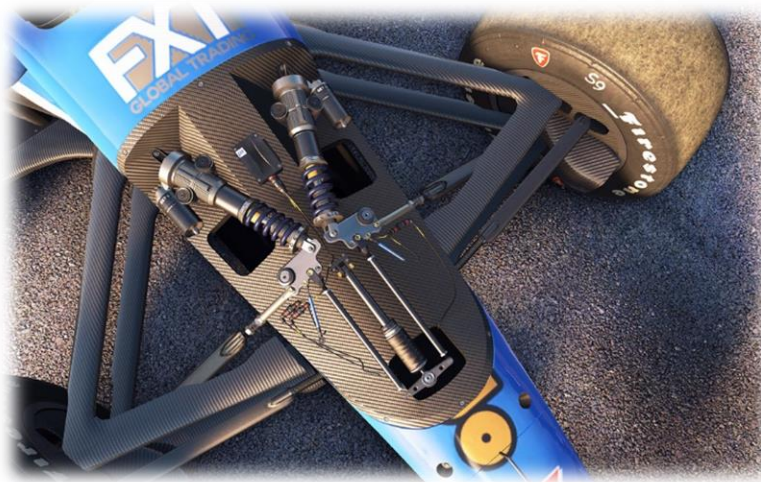
Figura 21 Suspensión multibrazo o de doble trapecio. Fuente: Indycar
