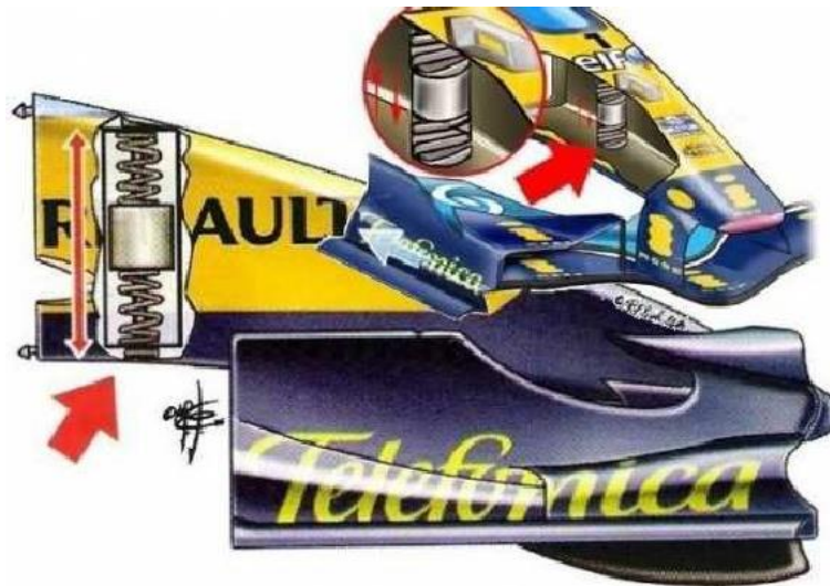
Figura 10 Mass Damper del Renault R26. Fuente: Giorgio Piola
