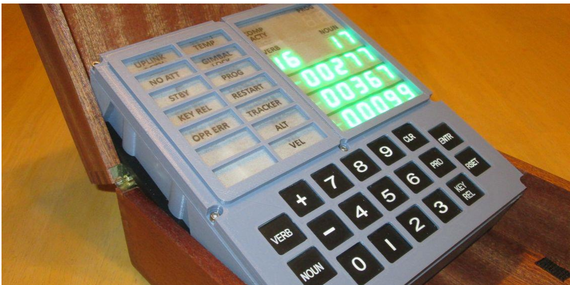
Ilustración 4 - Prototipo del AGC de la empresa S&T Geotronics LLC [22]
