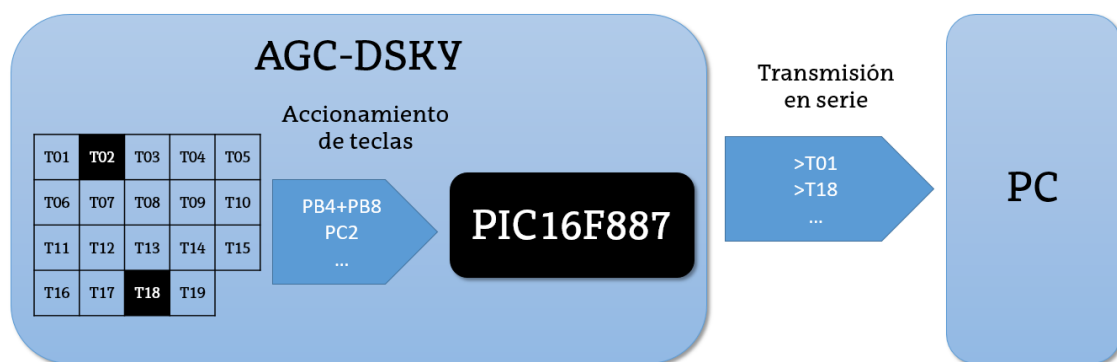
Ilustración 11 - Esquema del módulo SW de control del teclado
