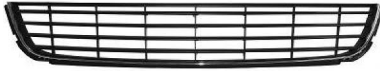
Figura 1. Rejilla de ventilación del parachoques delantero del VW Polo 2012
