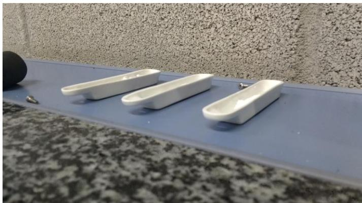
**Figura 16. Crisoles para el horno horizontal**
