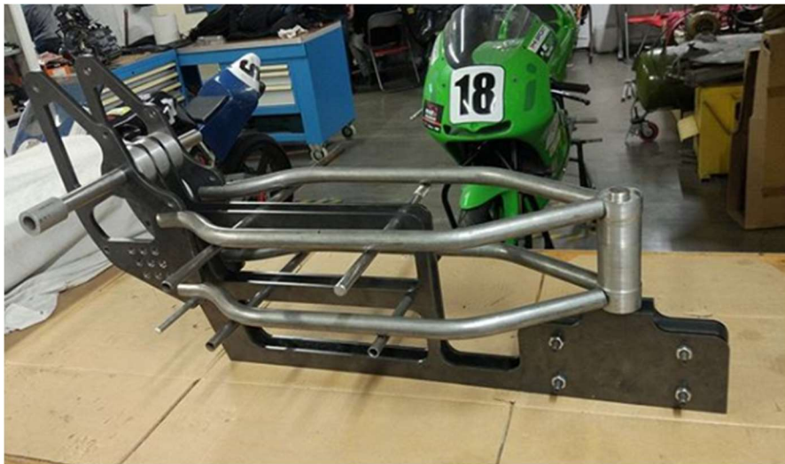
Ilustración 21: Montaje del chasis en el soporte (sin montantes)
