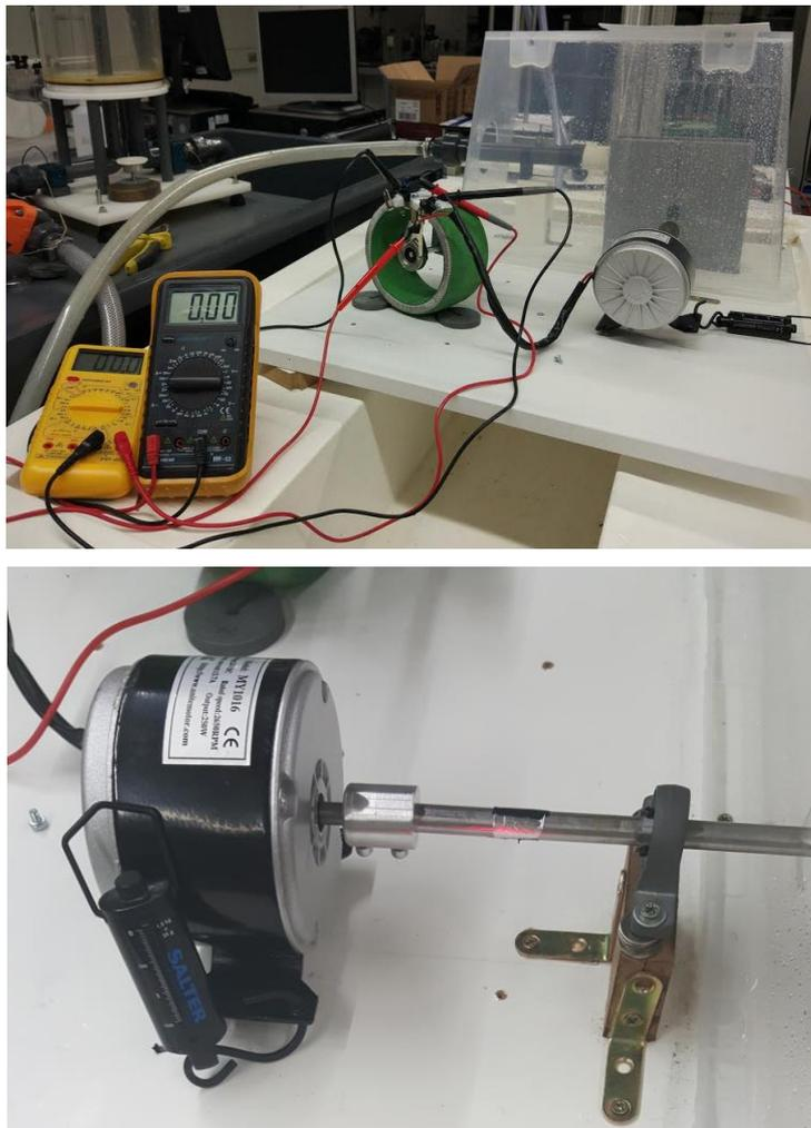
Figura 105. Ensayo de la maqueta con máquina de cc
