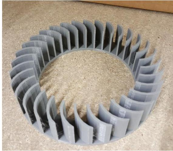
Figura 77. Parte del rodete de la turbina banki para la maqueta
