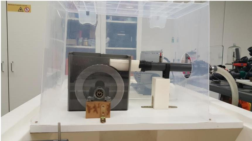
Figura 78. Maqueta vista de la turbina, la caja de protección y el distribuidor
