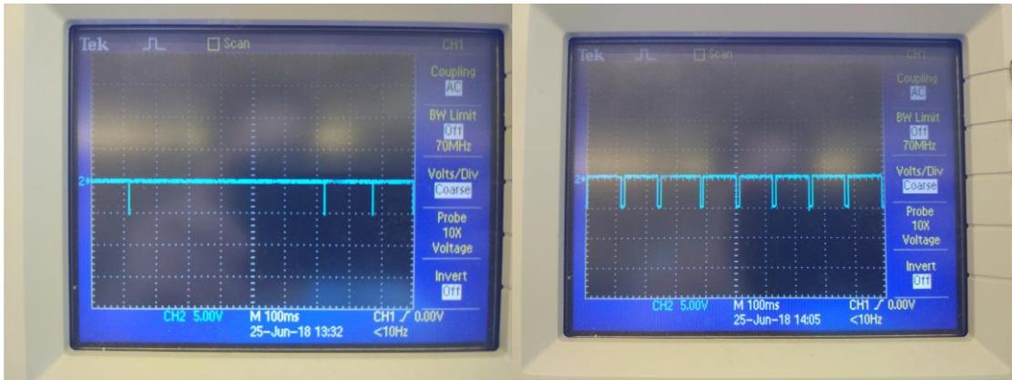
Figura 97. Resultados duty cycle ensayo real monofásico 21,7 A. 50 Hz (Izda) y 55 Hz (Dcha)
