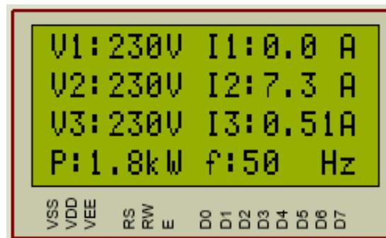
Figura 102. LCD simulación caso trifásico con una carga.
