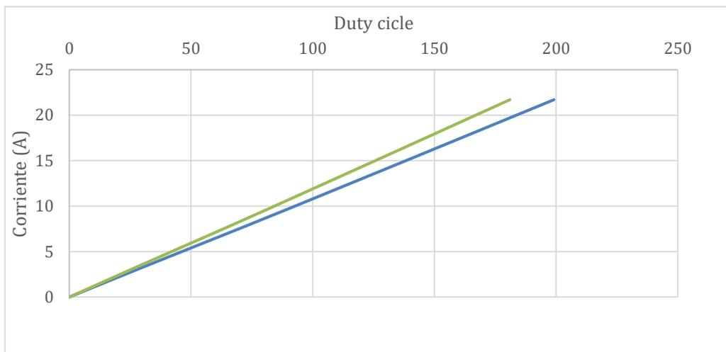
Figura 92. Diferencia entre el duty cycle con 50 (azul) y 55 (verde) Hz
