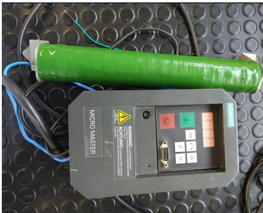
Figura 83. Variador de frecuencia Micromaster 440 y reóstato de frenado
