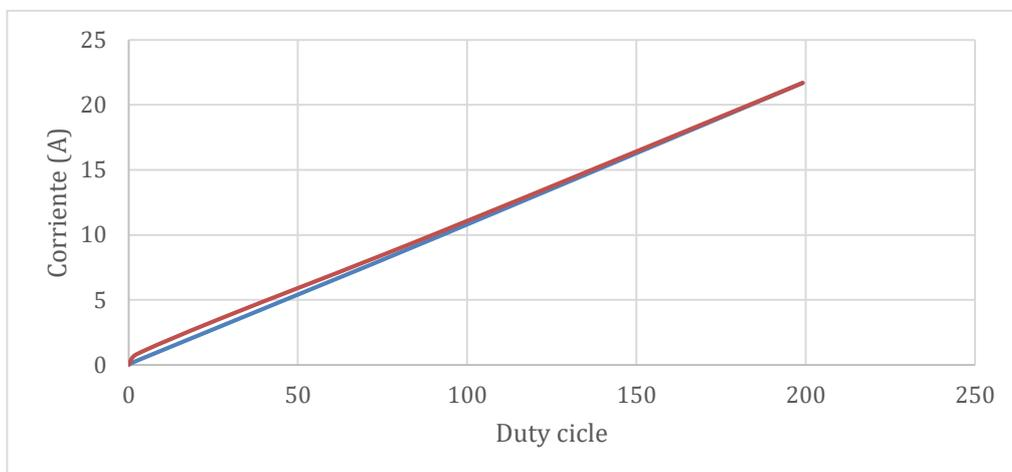
Figura 93. Diferencia corriente real simulación (Roja) y corriente obtenida (Azul).
