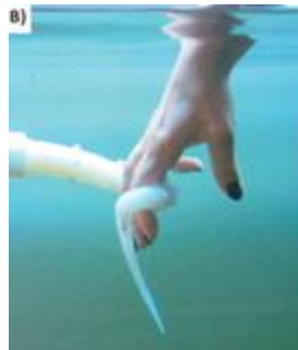
Figura 3. Robot inspirado en el movimiento de un pulpo
