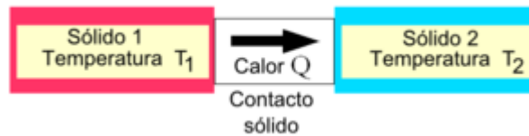
Figura 48 Transmisión de calor por conducción
