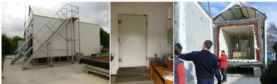
Fig.2.2 Izda: Detalle del exterior de la célula Paslink, fachada de orientación oeste. Centro: sala de servicios ,en su interior se encuentra la instrumentación de control de la célula de ensayo. Dcha.: interior de la celda de ensayo sin muestra, fachada de orientación sur Definición de los componentes de ensayo
