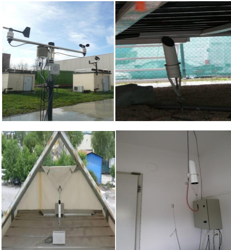
Fig. 2.15 Detalles exteriores de la célula para la medida de temperatura de aire exterior
