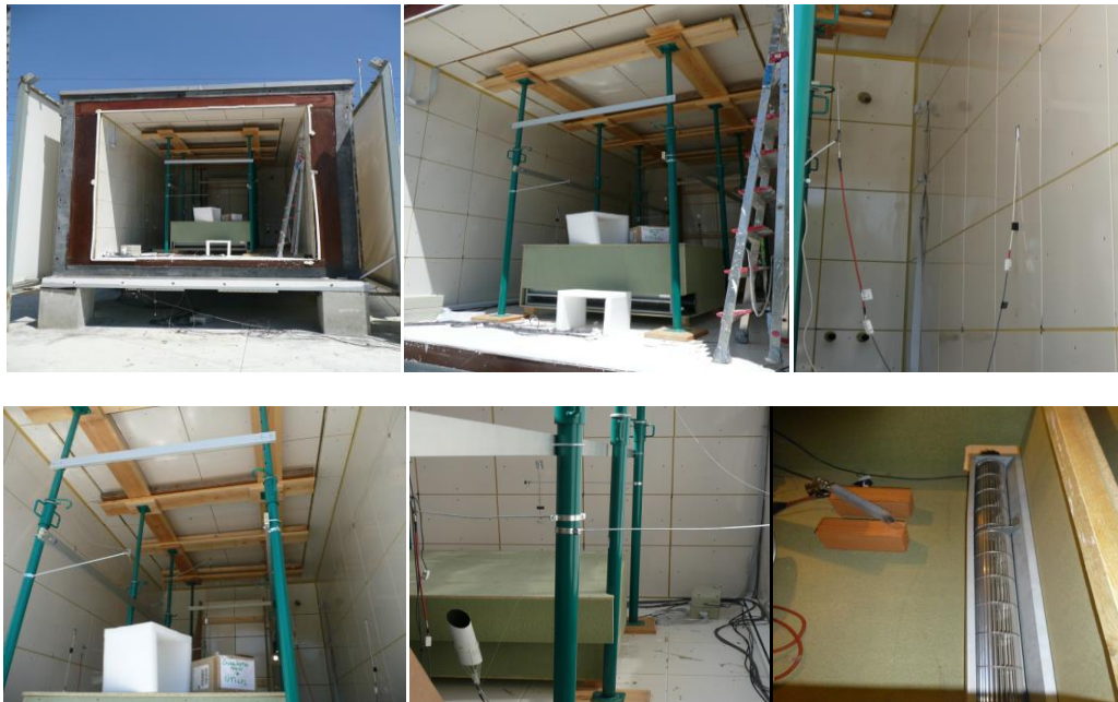
Fig. 2.14 Detalles interiores de la célula para la muestra de temperatura de aire interior
