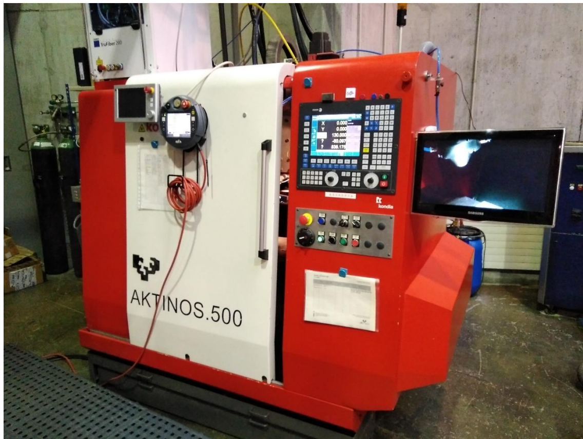
Ilustración 10. Centro de procesamiento láser “Kondia Aktinos 500”
