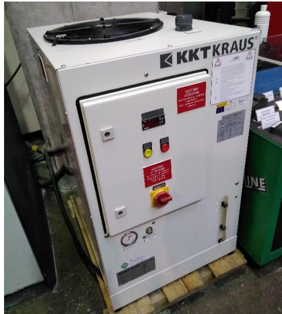
Ilustración 8. Sistema de refrigeración “KKT Kraus OLB-5”
